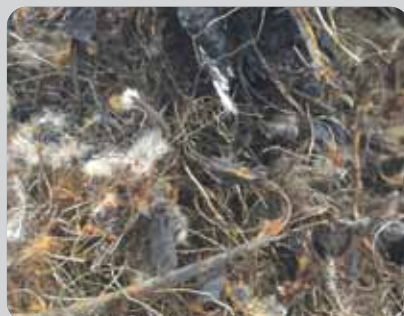
Ferro da impianto trattamento PFU
